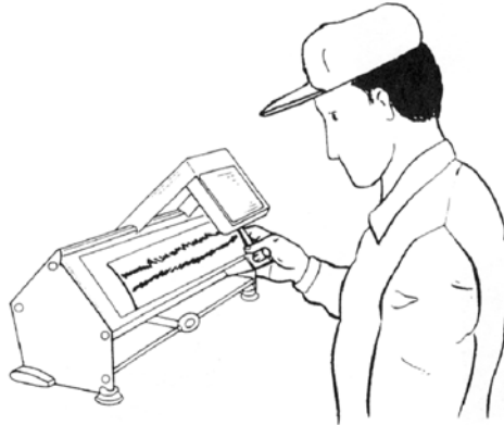
Gambar V.17 Pembacaan hasil uji radiografi
