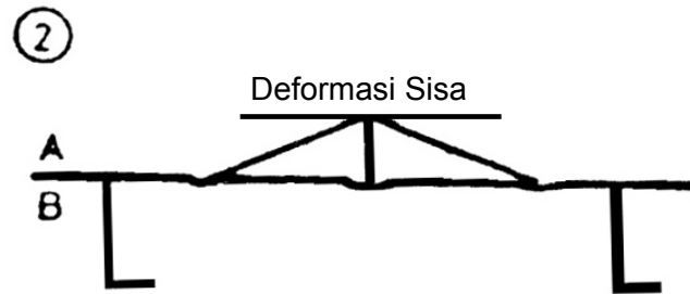
Gambar IV.71 Pelurusan dengan bantuan gaya luar
