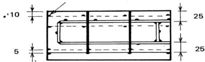
Gambar III.102 Las ikat pada plat dasar
