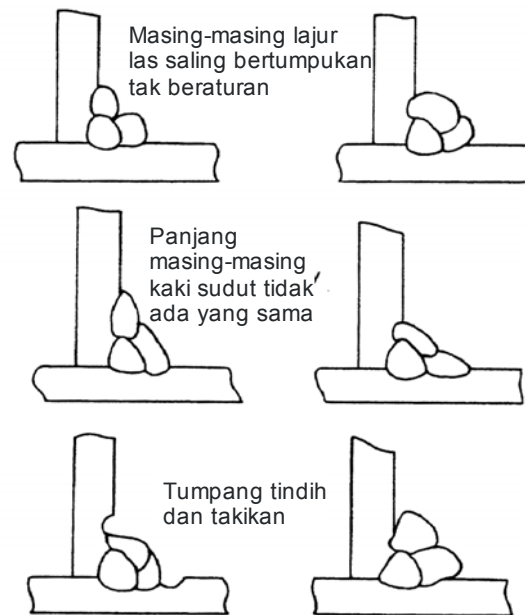
Gambar III.47 Contoh las T yang buruk
