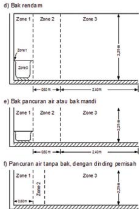
Gambar 8.23-2 – Klasifikasi zone dalam kamar mandi (tampak samping)
