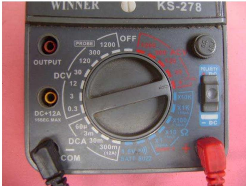
Kalau DCA untuk mengukur besarnya arus,tetapi di rangkaian elektronik jarang sekali digunakan karena hanya arus lemah / kecil.
