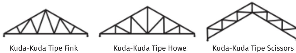
Gambar 5.45 Kuda-Kuda Tipe Atap, Tipe Fink, dan Tipe Scissors
