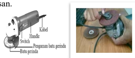
Gambar 4.12 Bagian Mesin Gerinda Tangan
